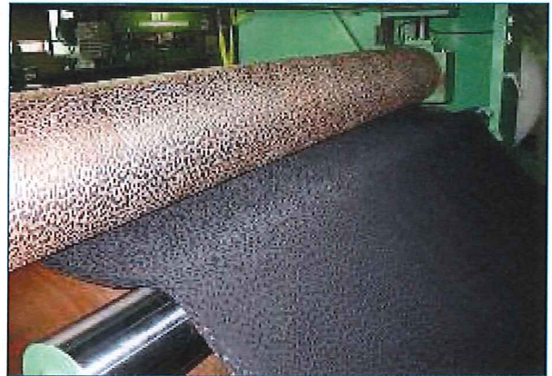
多色グラビア印刷機 (エンボスロールによるしぼ押し)
